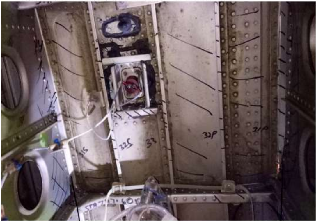
RH Stringer 31S Keel Web Damage
